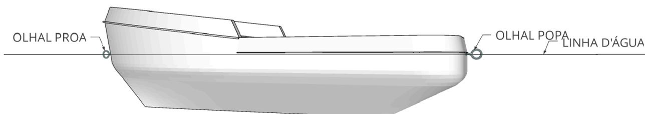
O centro dos olhais de reboque devem estar localizados na linha d'água, com tolerância de  $\pm 10$  mm. Os olhais devem ser fechados e devem estar centralizados em relação ao casco da embarcação. O diâmetro interno (D) e a base do olhal são identificados na figura 6. Destaca-se que **obrigatoriamente** ambos os olhais devem ser removíveis.
