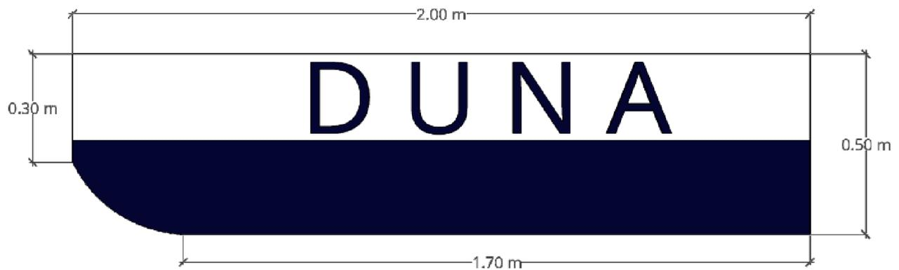
*Figura 12 – Vista superior da barcaça (obs.: para a prova de Manobrabilidade a popa da barcaça é plana)*
